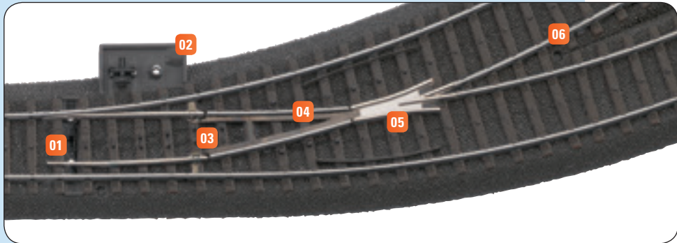
01 Einzel gelagerte gegossene Weichenzungen 02 Vorbildgerechte Ausmauerung am Stellmechanismus 03 Durchgehende Kontaktgabe von den Zungen bis zum Herzstück 04 Zwischenschienen aus Profilmaterial 05 Eingesetztes Herzstück aus Metall 06 Weichenbogen als Kreisausschnitt 30° Radius 360 mm
