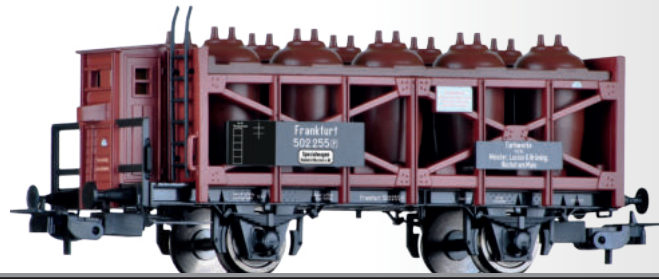
Säuretopfwagen „Farbwerke Höchst a. Rhein“, eingestellt bei der K.P.E.V. Acid pot car "Farbwerke Höchst a. Rhein" of the K.P.E.V.
