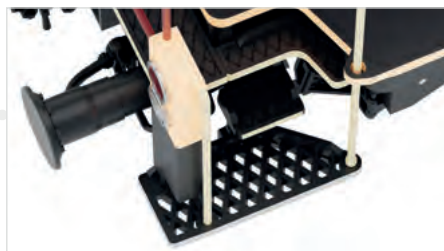
Durchbrochen dargestellte Trittstufen
