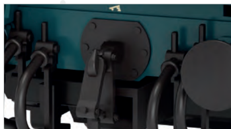
Vorbildgerechte Umsetzung der Aufnahme für die Automatische Kupplung
