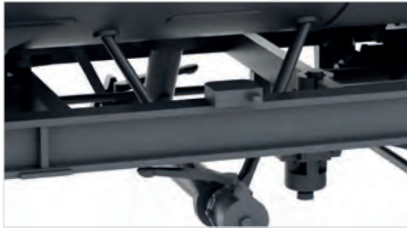
Entladeeinrichtung mit diagonaler Befestigung
