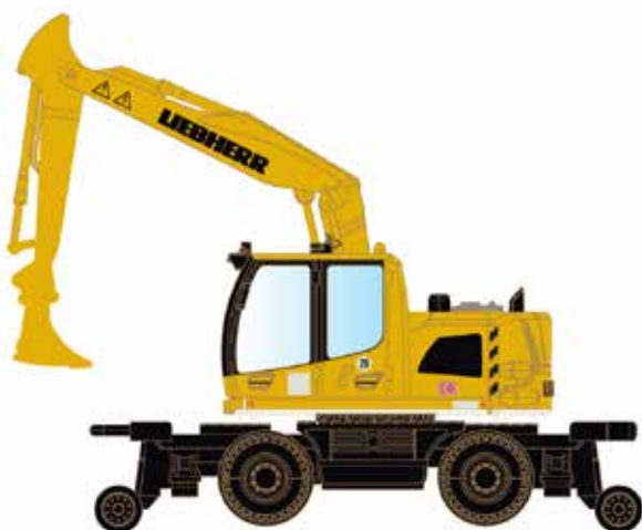
LC4270 ZWEIWEGE-BAGGER LIEBHERR A922 RAIL - DB BAHNBAU
