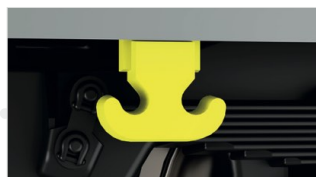
Separátně osazované tažné kotvičky
