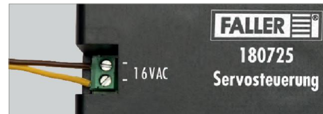
Obr. 2: Připojení napájecího napětí
