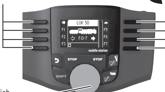
Ändern der Fahrtrichtung durch Drücken des Drehreglers.
