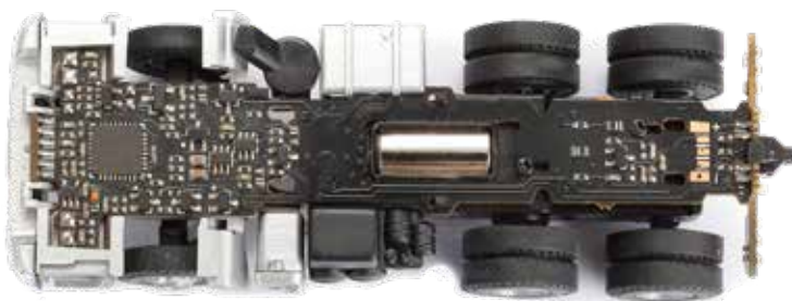
Platine dient als Chassis
