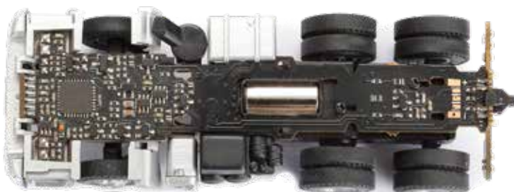
Platine dient als Chassis
