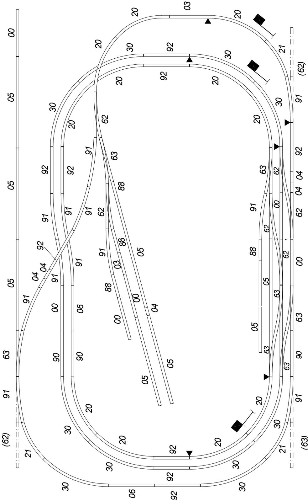
alle Gleis entsprechen der Type. 85... z.B. 8500
