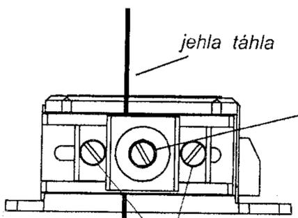
uchycení jehly a výškový posun- uvolnění šroubu a posunem jehly (2 drážky pro různé průměry jehly)
