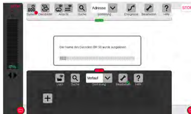
Der Decoder (die Lok) ist nun am Gleis, die Anmeldung beginnt ..
