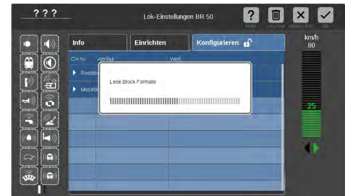
.. die „Blöcke“ (das sind die Gruppen von Konfigurationsparametern) vom Decoder eingelesen und geöffnet (Rootblock, Motorblock, Formate, Sound, usw.).
