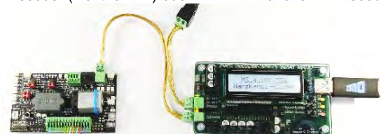
ein bedrahteter Decoder zum SW-Update, Sound-Laden, Testen an MSTAPK ; Verbindung zu MXULFA über „Schiene“, Software und Sound-Projekte vom USB-Stick.
