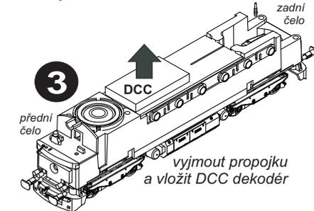
vyjmout propojku a vložit DCC dekodér
