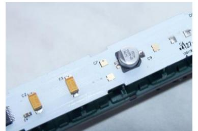
Na plošnom spoji je miesto na prispájkovanie kondenzátorov slúžiacich ako zásobník energie počas krátkodobých výpadkov napájania. Jedná sa hlavne o vagóny Tillig, kde je napájanie len z jednej strany. Vhodné kondenzátory sú tantalové veľkosť D - EIA 7343-31 (7.3 mm × 4.3 mm × 3.1 mm) alebo elektrolytické SMD ( $\varnothing 8 \times 5.4\text{mm}$ ,  $\varnothing 6.3 \times 5.4\text{mm}$ ) na 6.3V
